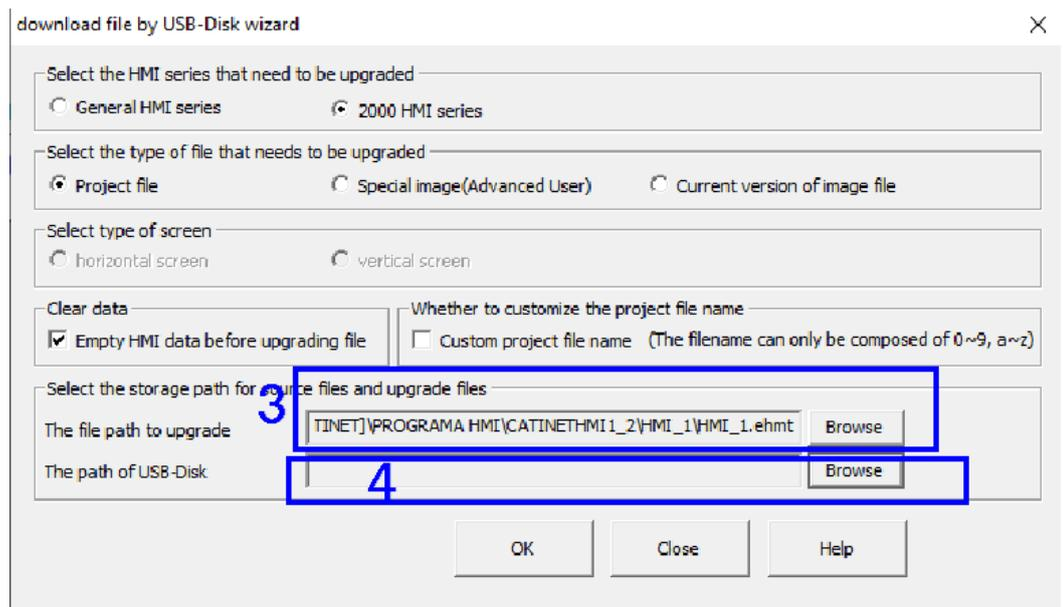
5 - Utilizar la guía para cargar el programa de la USB a la pantalla, para hacer la carga del programa sobre la pantalla.
